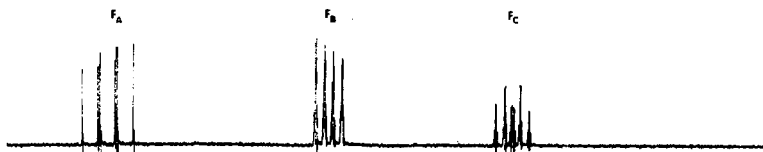
Abb. 5. 19 F-Kernresonanzspektren von cis -H 3 C-SF 4 -Cl. Das hochaufgelöste Spektrum beweist die Existenz von drei verschiedenen Arten von Fluoratomen im Verhältnis 1:2:1. Die zur Methylgruppe cis -ständigen Fluoratome (F B und F C ) zeigen eine Quartettaufspaltung wegen der Kopplung zu den Methylprotonen. Zahlenwerte siehe experimenteller Teil
